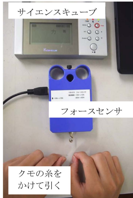
図3 ■ 糸の強度測定方法
