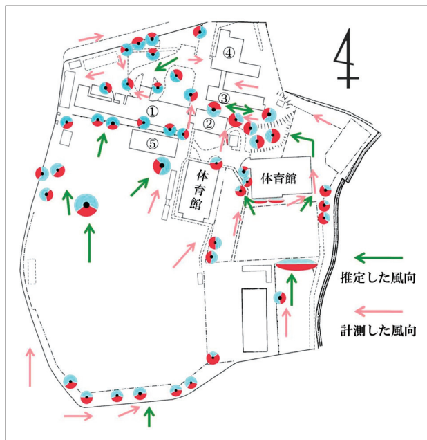
図2 ■ 校庭周辺での風向の比較（塩害状況から推定した台風接近時と計測した晴天・海風時）
