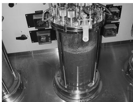
図2 ■ サツマイモのアルコール醗酵（5リッターファメンター）
