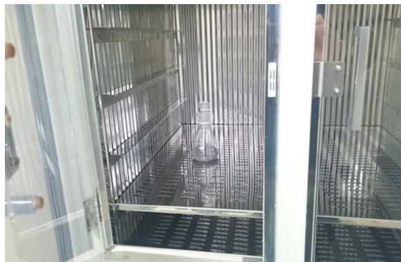
図2 ■ 熱処理に用いた定温器
