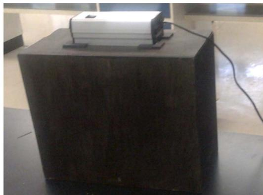
図1 ■ 紫外線処理に用いた木製の暗箱とブラックライト
